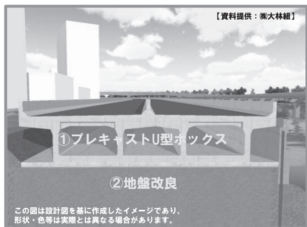
図—4 鮫洲埋立部の更新構造イメージ
