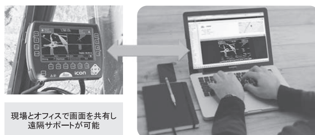
図—1 View：通信システムによるリモートアクセス
