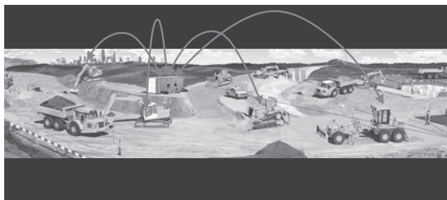
図ー2 Sync：現場事務所やオフィスと重機間で双方向のデータ通信
