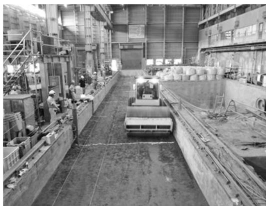
写真二 振動ローラ実験状況
