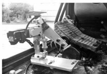
サーボモーター+円弧状ギヤで操作
