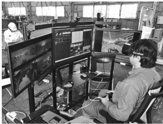
写真—10 屋外用 TORSO の外観と HMD を装着した遠隔操縦の状況
