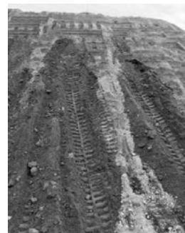
写真—13 勾配走行（登坂）試験（写真右はスリップ痕）
