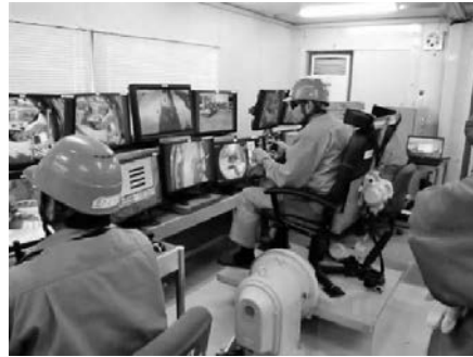
写真一 2 3D画像と体感型操縦を用いた「次世代無人化施工システム」
