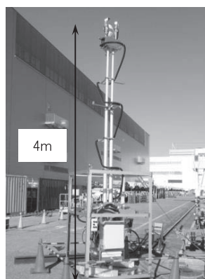
写真—11 自動昇降アンテナを有した基地局（左）と中継局（右）
