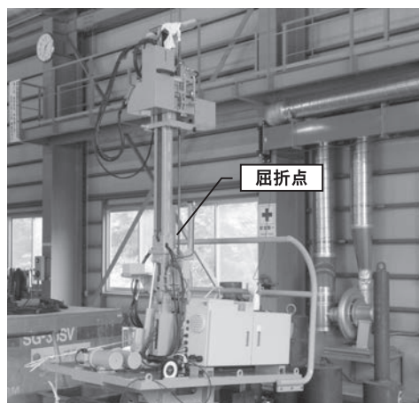
写真一九 ロボットに搭載する貫入試験装置
