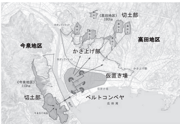
図一 切土部（赤）とかさ上げ部（黄）までの土運搬の流れ
