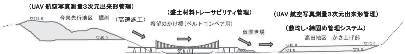
図二 今泉地区から高田地区かさ上げ部へ土の運搬イメージ（断面図）
