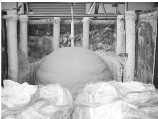
写真—1 確認された改良体（模型注入実験）
