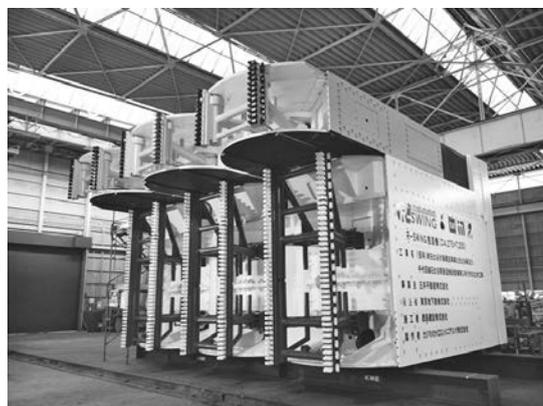
写真—4 鹿島建設 R-SWING 機 揺動型掘削機
