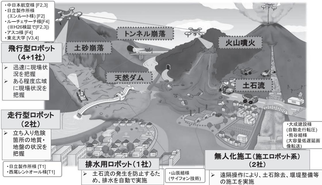
図-4 災害調査・応急復旧分野で「I（活用を推薦する）」の評価を得たものの一覧図
