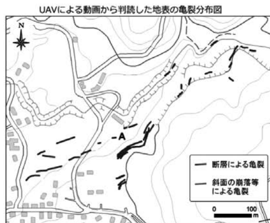
図一3 平成28年熊本地震のドローン利用事例（対象地域：南阿蘇村） 7) （左：断層を撮影した動画の静止画，右：動画から判読した亀裂）
