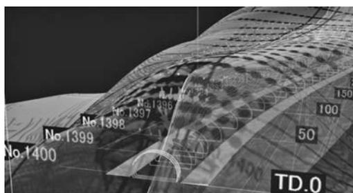
図-2 トンネル坑口における3次元変位状況
