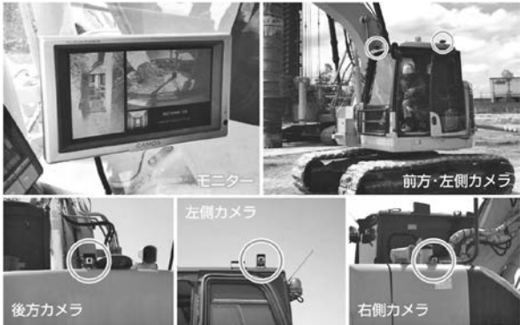
写真ー8 つくし工房 パノラマビュー 6501 全周監視モニター装置
