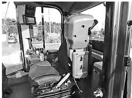
写真—5 跳ね上げ式レバーコンソール
