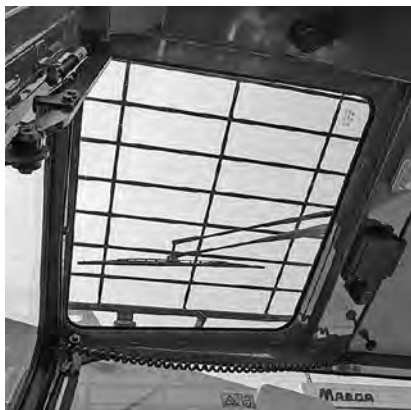
写真—8 天窓ワイパ全景
