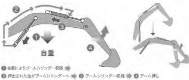
図一 4 油圧回生回路
