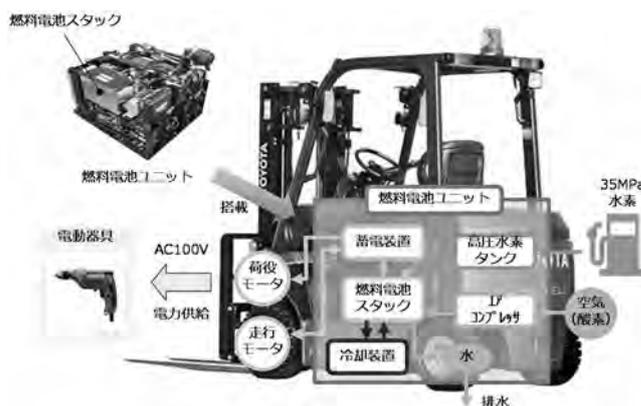
図-1 燃料電池システム概略図
