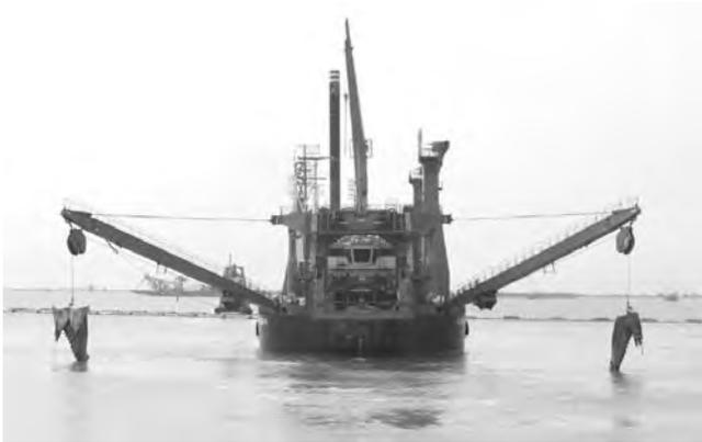
写真—3 アンカー打替状況
