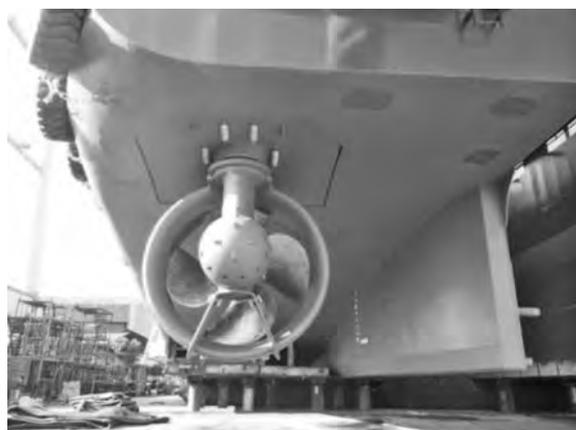
写真-2 Azimuth型推進器
