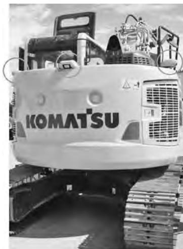
図-11 本システムカメラ設置状況
