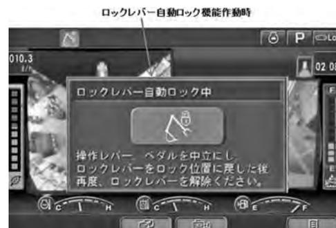
図-17 ロックレバー自動ロック機能作動時のモニタ表示
