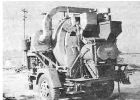
写真 3-22 MEMR-M52 型ポータブルアスファルトプラント
