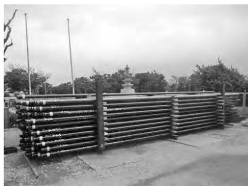
写真一九 油井用ネジ鋼管
