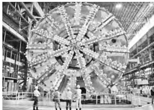
写真二 工場製作が完了した直径約 16m のシールドマシン
