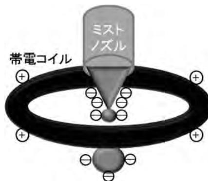
図一 帯電ミスト発生原理
