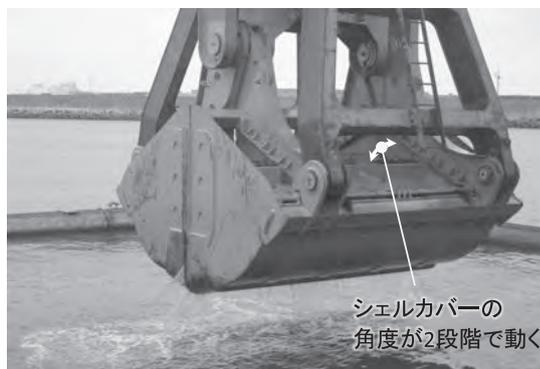
図-11 容量可変グラブバケット実機
