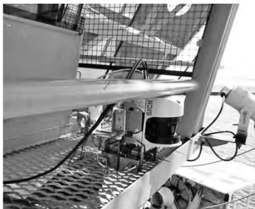
図一17 レーザー距離計
