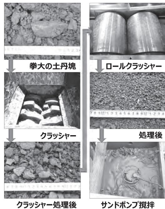
写真-2 土丹塊の解泥・溶解状況
