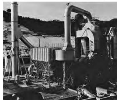
写真 3-56 日工製バグフィルタ
