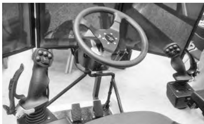
写真二 左右ジョイスティック及びステアリング
