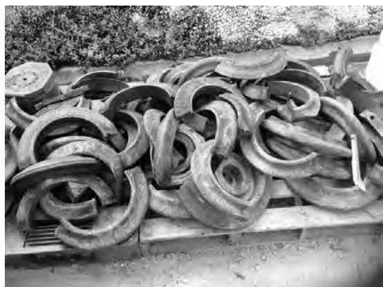
写真—2 カッターリング破損状況
