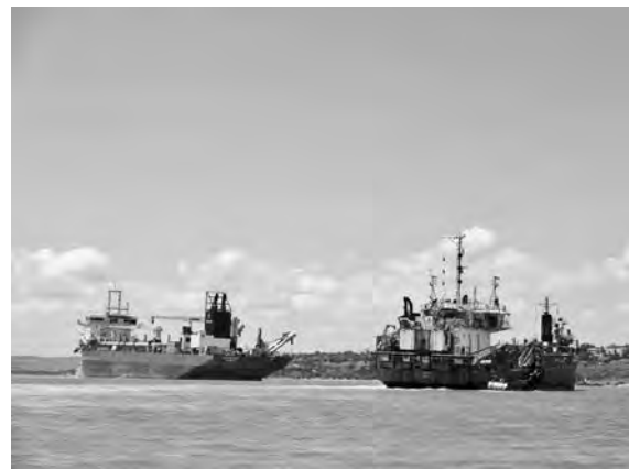
写真—1 ドラグサクシオン浚渫船掘削状況
