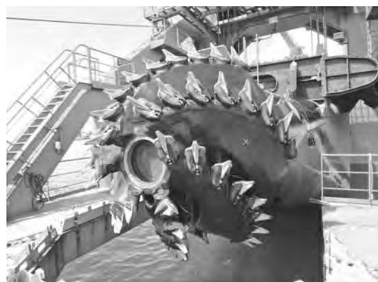
写真—4 カッターヘッド (硬土盤用)
