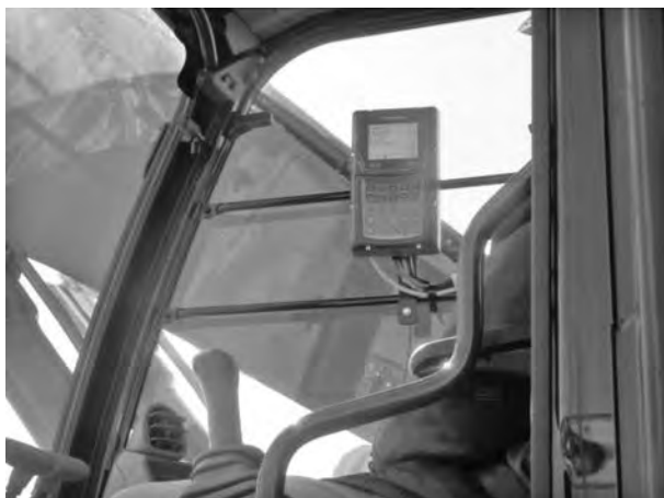
写真—2 荷重判定装置（ロードライト）
