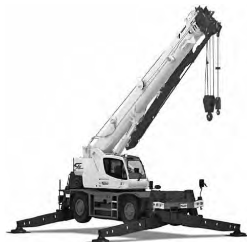
写真-8 タダノ GR-250N ラフテレーンクレーン (作業姿勢)
