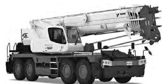
写真-7 タダノ GR-700N ラフテレーンクレーン (走行姿勢)
