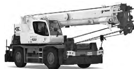
写真-9 タダノ GR-250N ラフテレーンクレーン (走行姿勢)
