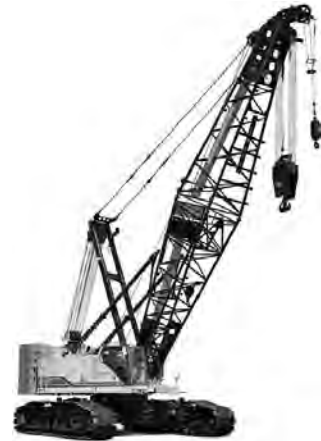
写真—4 日立住友重機械建機クレーン SCX1200-3 クローラクレーン
