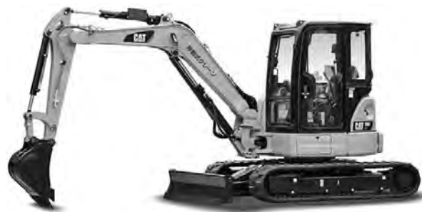
写真-1 キャタピラージャパン Cat 305E2CR 後方超小旋回型ミニ油圧ショベル
