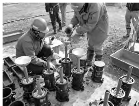
写真—6 φ 150 mm プレバックド工法供試体の作製状況
