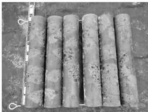
写真—5 試験用ブロックより採取したコア供試体 (プレバックド工法)
