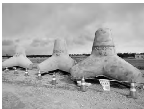
(a) 消波ブロック (プレバックド工法)
