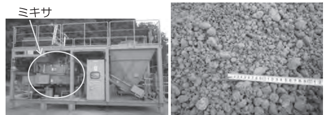
移動式ユニットプラント ベントナイト混合土 写真-3 ベントナイト混合土の製造プラントおよびベントナイト混合土
