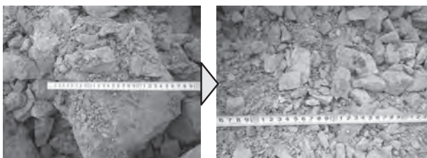
破碎前 一次破碎（40mm以下） 写真-2 簡易破碎前後の泥岩の様子
