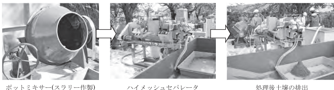
写真—2 ハイメッシュセパレータ試験状況
