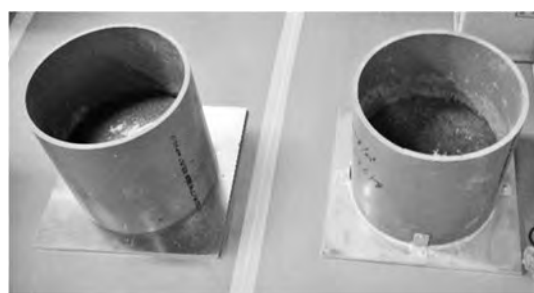
写真—3 セメント改良土供試体（左：80 kg/m 3 、右：120 kg/m 3 ）
