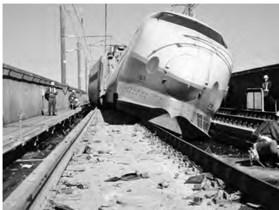
写真一3 新潟県中越地震による上越新幹線列車の脱線
