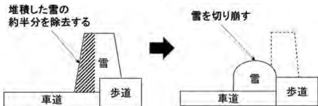
図一 1 拡幅作業のイメージ
