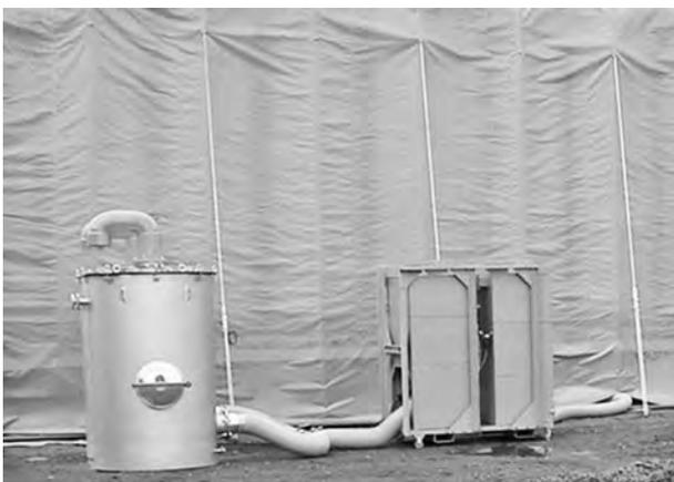
写真—6 テント内排ガス処理装置
