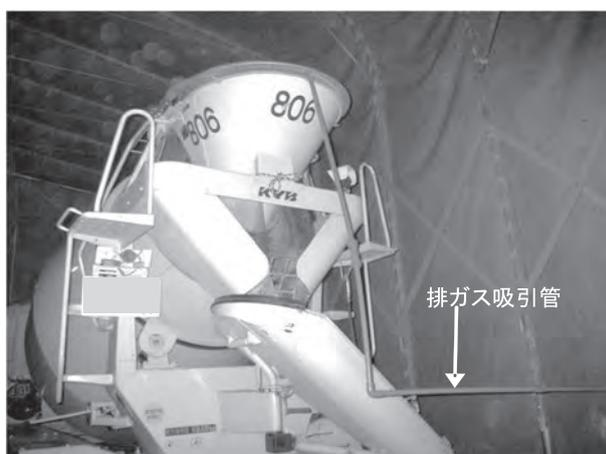
写真一 2 微生物反応浄化装置
