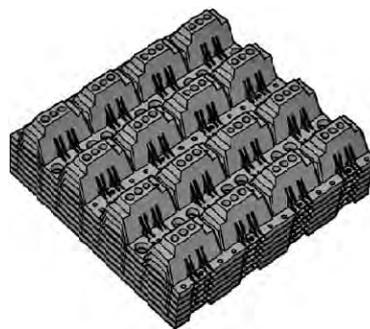
図—2 運搬時の積層状態
