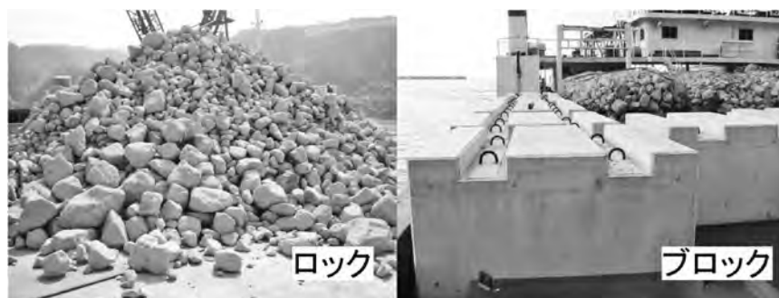
写真—1 鉄鋼スラグ水和固化体 1)
