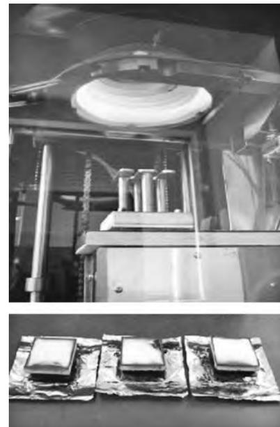
写真-4 発熱性試験 (上) と試験後のサンプル (下)
