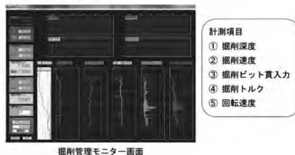
図一 10 掘削管理システム
