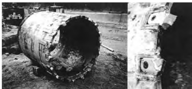
写真—2 ケーシングと先端の掘削ビット
