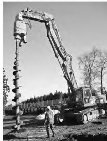
写真—6 大型バックホウタイプ
