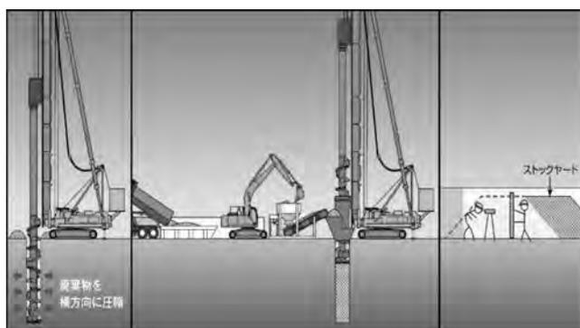
図二 海面処分場での施工手順
