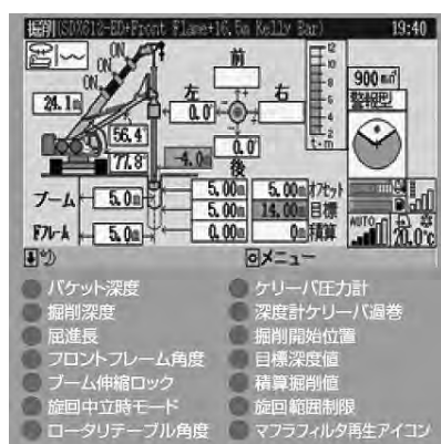
写真—6 大型モニタでの集中表示
