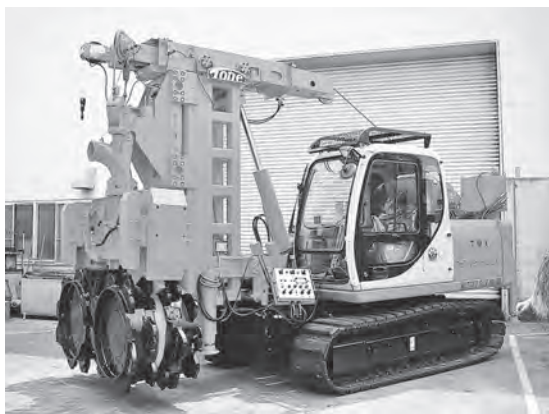
写真—3 MPD 型ベースマシン搭載 水平多軸掘削機
