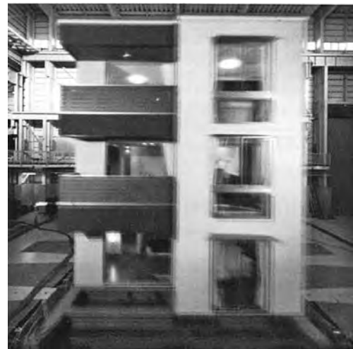
写真-2 実大振動実験(本BF構法)
