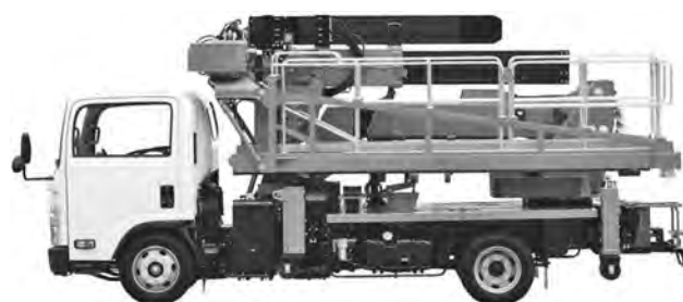
写真7 アイチコーポレーション SF77B1FR 橋梁点検作業車（格納姿勢）
