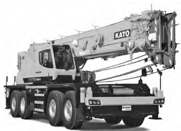
写真—6 加藤製作所 SL-850Rf PREMIUM ラフテレーンクレーン（伸縮ブーム型）
