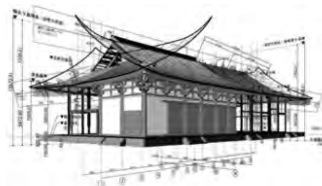
図—13 規矩術を用いた統合モデル（BIMモデル）
