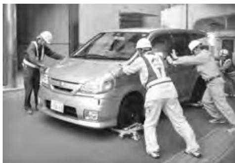
写真-2 車両移動用ジャッキの外観と移動作業状況
