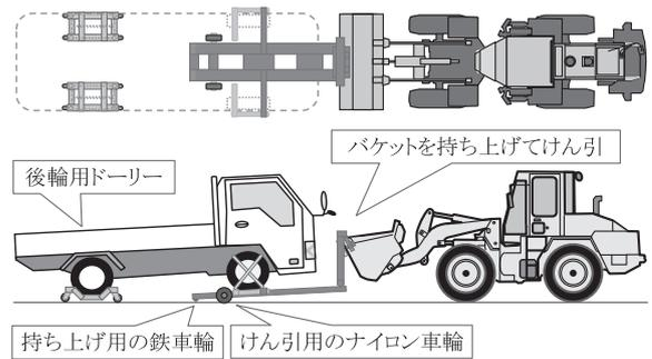
図-1 テコの原理で前輪を持ち上げる1次試作機
