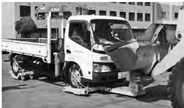
写真一九 1次試作機によるけん引作業状況
