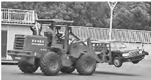
写真-3 ホイールローダーによる乗用車の移動作業状況
