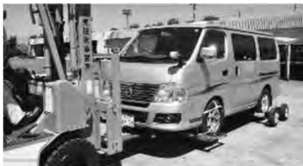
写真-5 専用アタッチメントを利用した移動作業状況
