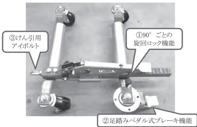
写真-6 追加改良後の車両移動用ジャッキ
