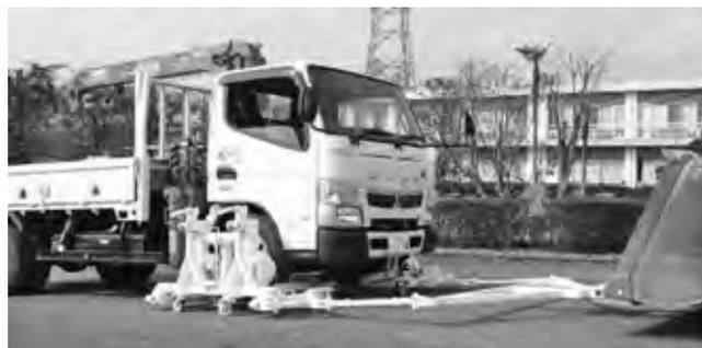
写真一〇 2次試作機によるけん引作業状況
