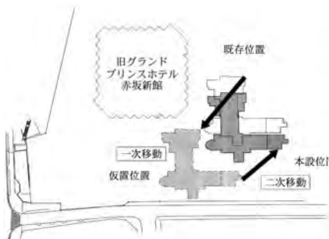
図—4 移動概要図（曳家重ね図）
