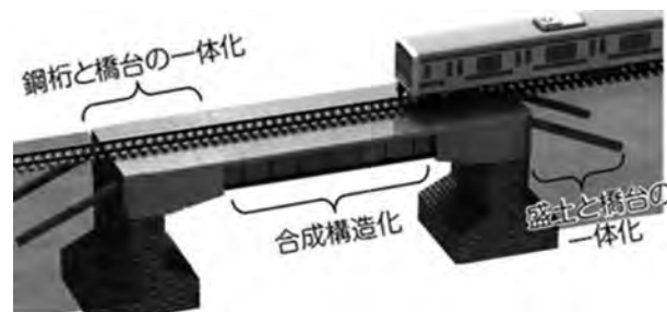
図—2 鋼橋・橋台・盛土一体化工法 5)
